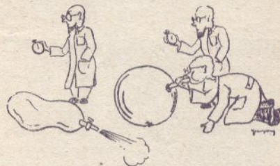
Rys. 3. Z lewej — zasada szybkościomierza. Im silniej dmucha Wasz kolega, tym bardziej rozszerza się dętka piłki. Z prawej — zasada wariometru. Wąska rurka obok membrany nosi nazwę włoskowatej.
