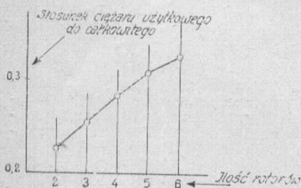
Rys. 2. Im więcej rotorów posiada śmigłowiec, tym więcej może zabrać ładunku w stosunku do ciężaru własnego
