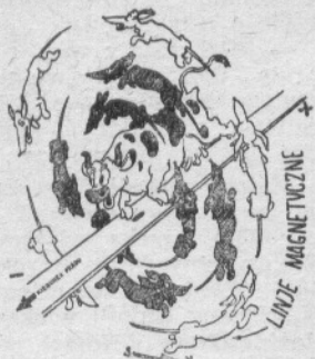
Rys. 4 — Prąd przepływający przez przewodnik wytwarza wokół niego pole magnetyczne. Linie magnetyczne przedstawiają jamniki, a ta krowa w środku obrazuje prąd elektryczny
