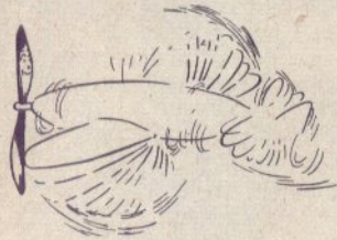
Rys. 19. Śmigło... stara się zmusić samolot, aby się kręcił w przeciwną stronę niż ono
