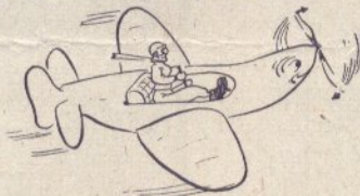
Rys. 20. Gdy pilot skłoni na prawo — samolot podnosi nos do góry
