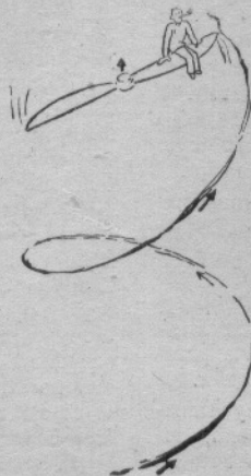
rys. 6 ...łopatka śmigła zakreśla w przestrzeni powierzchnię śrubową...
