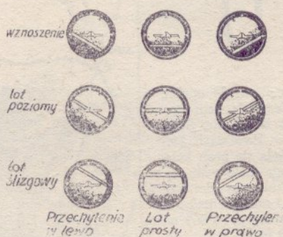
Typowe wskazania sztucznego horyzontu w różnych fazach lotu.
